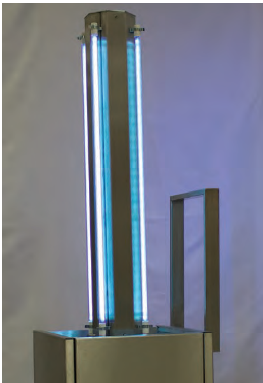
Dettaglio lampade UVC durante il processo di sanitzizzazione.
