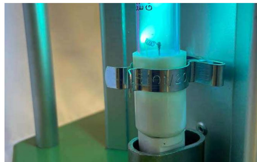
Dettaglio lampade UVC durante il processo di sanitizzazione.
